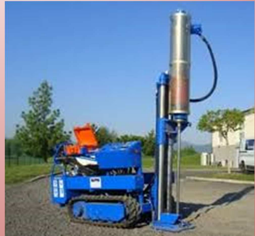
Pénétrromètre dynamique (masse mouton 63,5 kg)
