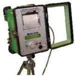
MODULSCAN Enregistreur de l'essai pressiométrique
