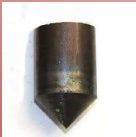
Pénétrromètre dynamique (pointe de 20 cm 2 ) Minimum de un profil à 3-4 mètres
