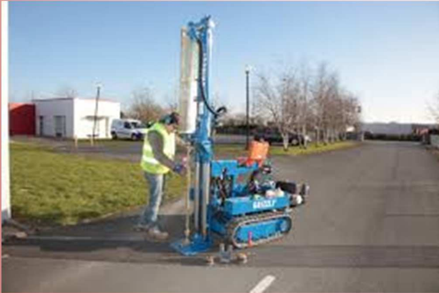
Pénétrromètre dynamique (pointe de 20 cm 2 ) Minimum de un profil à 3-4 mètres
